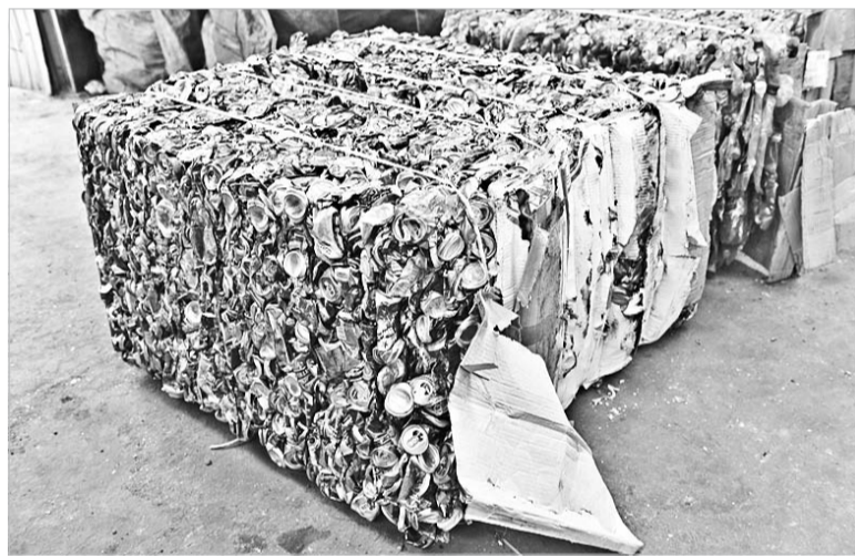
Полезные фракции — например, алюминиевые банки — после сортировки уплотняются в брикеты и в таком виде отправляются на переработку.
